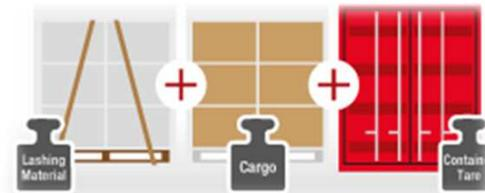
Pesando todos los bultos y elementos de carga, incluido el material de trinca y aseguramiento, sumándole la masa de la tara real del contenedor.
